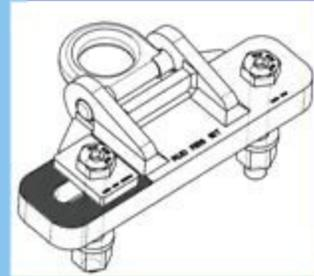
40 kilogramos, es solidario a una placa base que se fija mediante dos tornillos imperdibles a la brida del sector tubular del aerogenerador, pudiendo admitir espesores de brida de 50 mm hasta 125 mm y con distancia variable entre agujeros que se compensa gracias al agujero rasgado de la placa base, donde el tornillo se ajusta a la distancia requerida. El aro de carga se ensaya 100% contra grietas.
