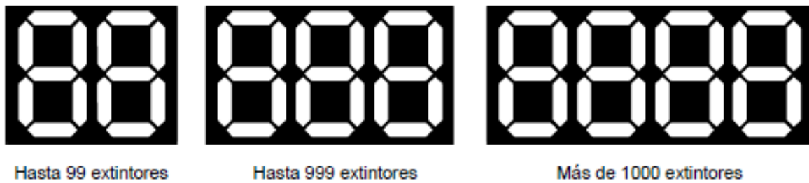
Figura 2 - Numeración de los extintores
