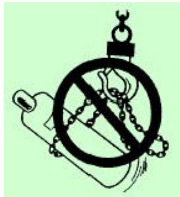
Indicador de prohibición de utilización de cadenas o cables para transportar botellas de gas
