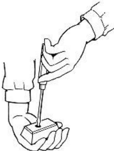
**Sujeción incorrecta de una pieza a atornillar**
