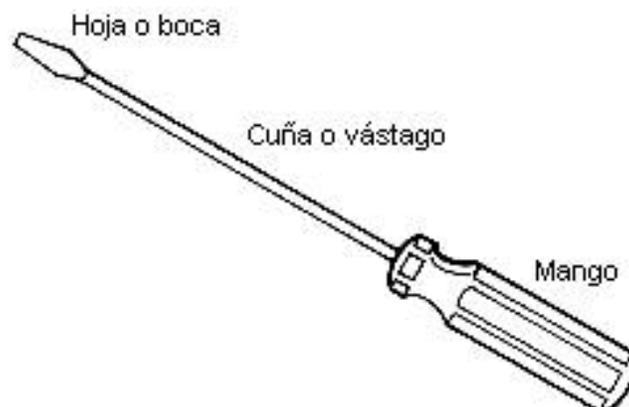
**Partes de un destornillador**
